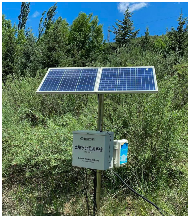
图 4-4 彭阳王洼土壤水分监测系统、海原县检查仪器运行状况
